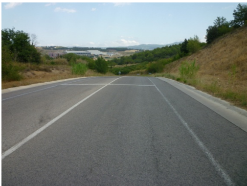
Imatge 35. Pendent i bandes transversals d'alerta.
