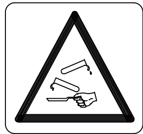
PERILL DE CORROSIÓ
