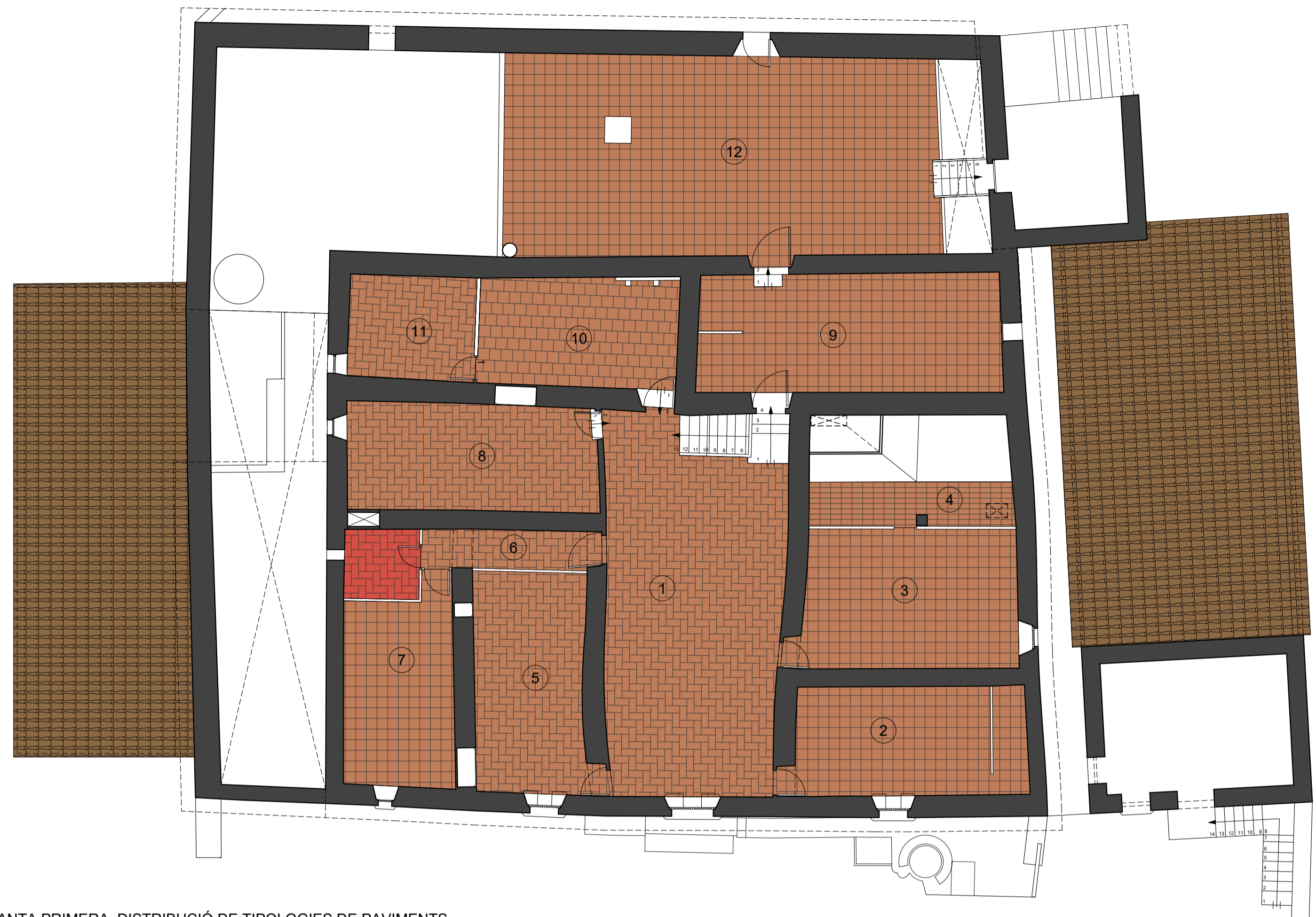
PLANTA PRIMERA. DISTRIBUCIÓ DE TIPOLOGIES DE PAVIMENTS
